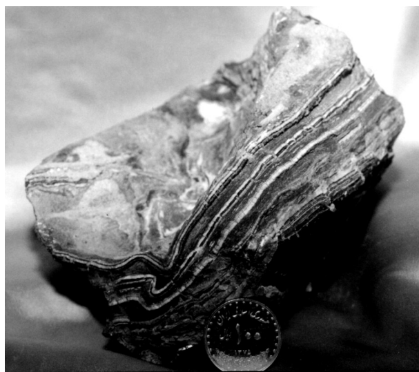
شکل ۱۶- لایه بندی متناوب انیدریت و کربنات.
