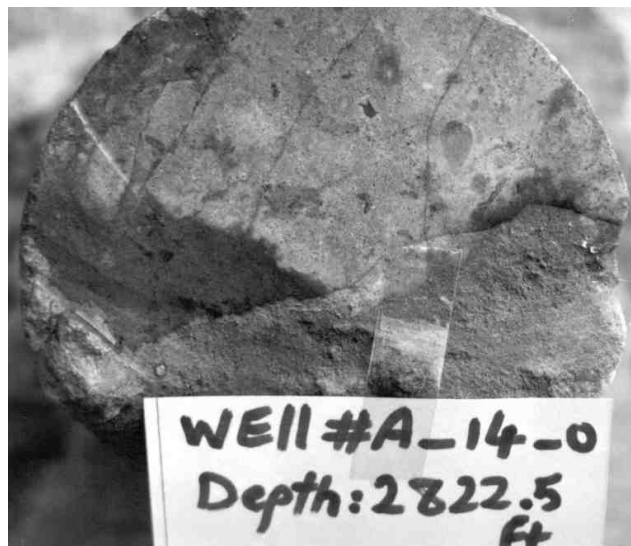
شکل ۳- شکستگی‌های پراکنده در ماسه سنگ کوارتز آرنایت که توسط سیمان کریستاله پر شده اند (بخش ۳، عمق ۲۸۲۲/۵ فوت)
