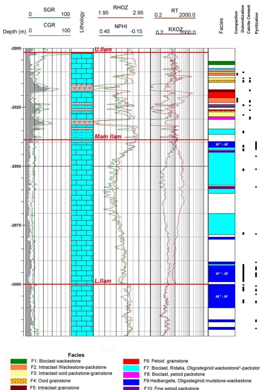
شکل ۲: ستون چینه‌شناسی سازند ایلام، نمودارهای پتروفیزیکی (شامل گامای طیفی، نوترون، چگالی و مقاومت) و توزیع میکروفاسیس‌ها در طول ستون چینه‌شناسی.
