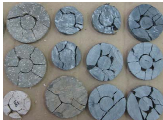
شکل ۱۶: تصویری از نمونه‌های شکسته شده توسط دستگاه پانچ استوانه‌ای
