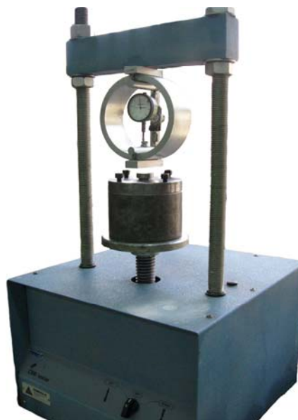
شکل ۱۴: تصویر ابزار آزمایش پانچ استوانه‌ای جایگذاری شده در دستگاه CBR
